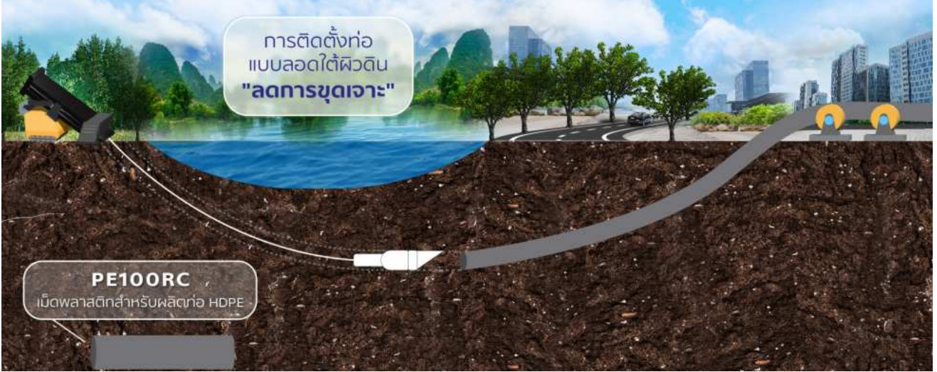
▶ เม็ดพลาสติก PE100RC สำหรับท่อนแรงดันสูง ช่วยให้วางระบบท่อใต้โดยไม่ต้องขุดเปิดหน้าดินหรือขุดเจาะถนน
